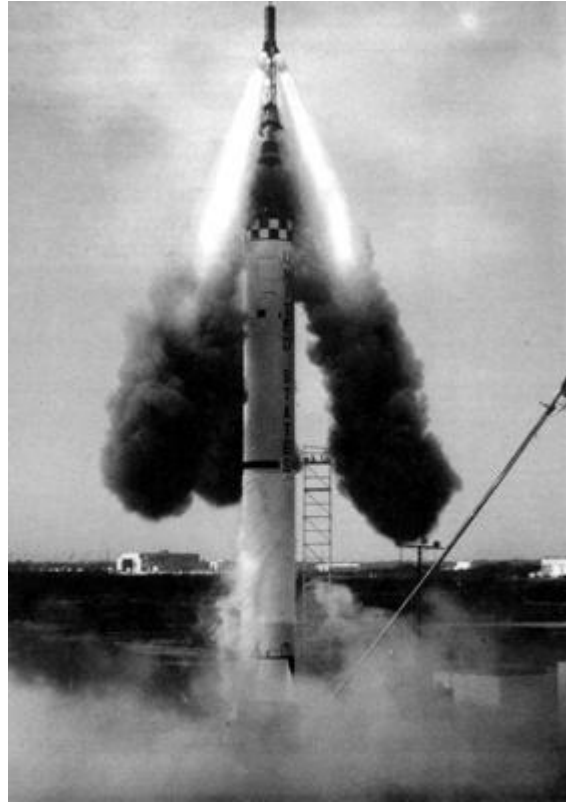
Figura 78. El lanzamiento de la misión MR-1 fue un fracaso, aunque rápidamente solucionado (en la fotografía, el dispositivo de emergencia conocido como «torre escape» acaba de activarse).
