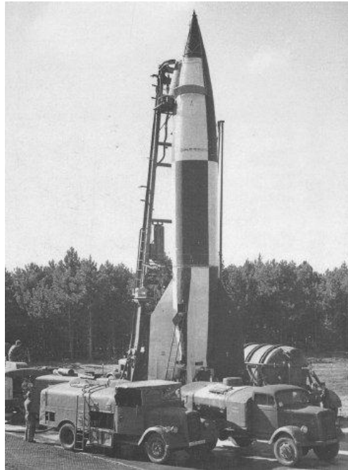
Figura 29. Las V-2 precisaban de un complejo soporte logístico para su lanzamiento, con decenas de camiones y centenares de soldados para ponerlas a punto. Ello limitaba severamente su operatividad bélica.
