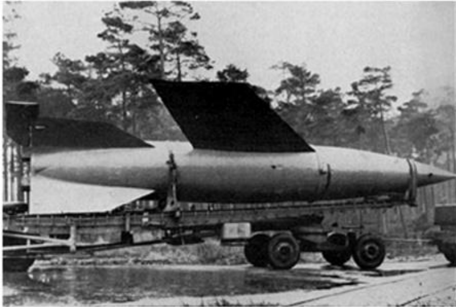
Figura 26. El A-4b, una versión simplificada del A-9: un A-4 con alas para incrementar su alcance.
